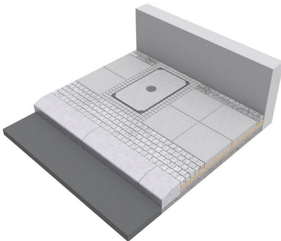
Wykończenie chodnika przy pokrywie studni telekomunikacyjnej
