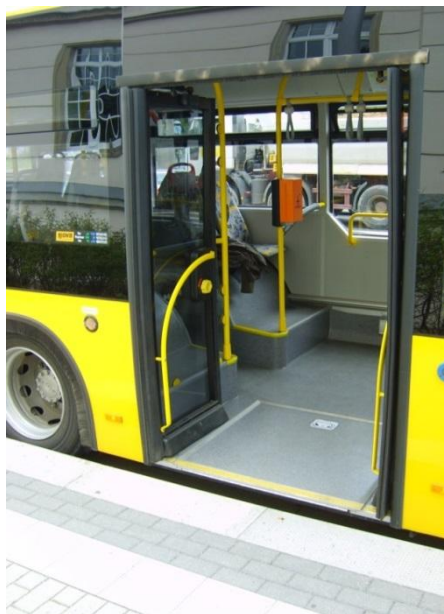
Rys. 9.8.2.2. Przerwa między peronem przystankowym a autobusem.
