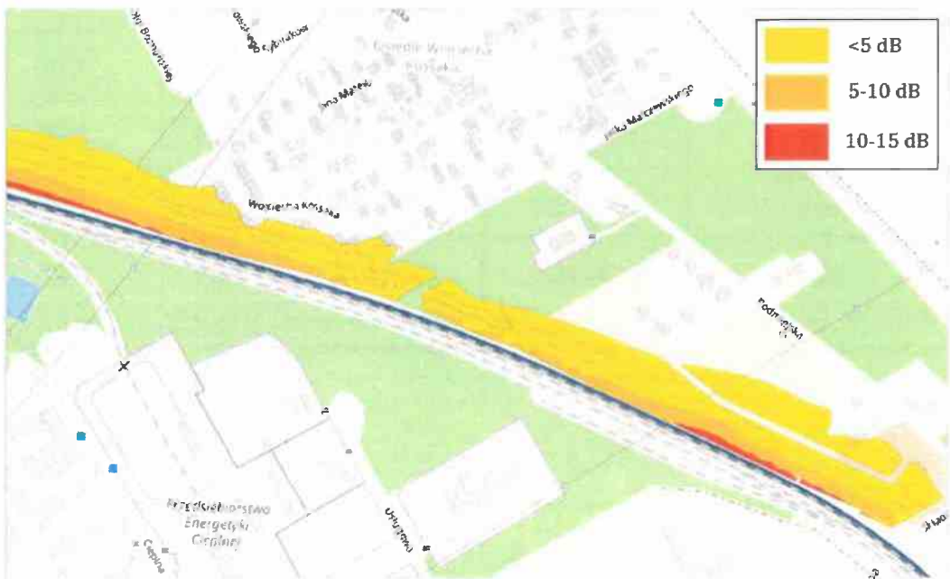
Rysunek 8. Mapa akustyczna dla linii kolejowej nr 351 na terenie miasta Stargard (przekroczenia dopuszczalnych poziomów hałasu - wskaźnik L_{dwn} )
